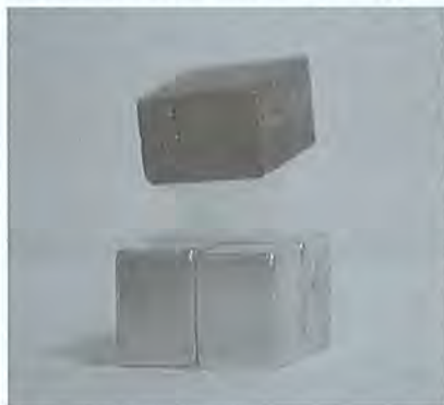
Abbildung 1: Ein Kuprat Hochtemperatur-Supraleiter der Verbindung \text{YBa}_2\text{Cu}_3\text{O}_7 (schwarzer Block) schwebt (levitiert) über einem Magneten. Der „Nebel“ wird durch den flüssigen Stickstoff verursacht mit dem der Supraleiter gekühlt wurde.
